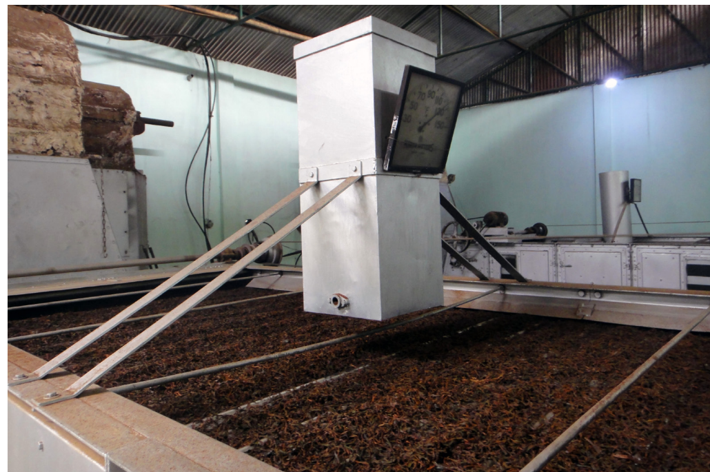
Die Trocknungsmaschine in Hatidubi, hier von oben; der Tee läuft zum Trocknen über mehrere «Stockwerke» durch.
